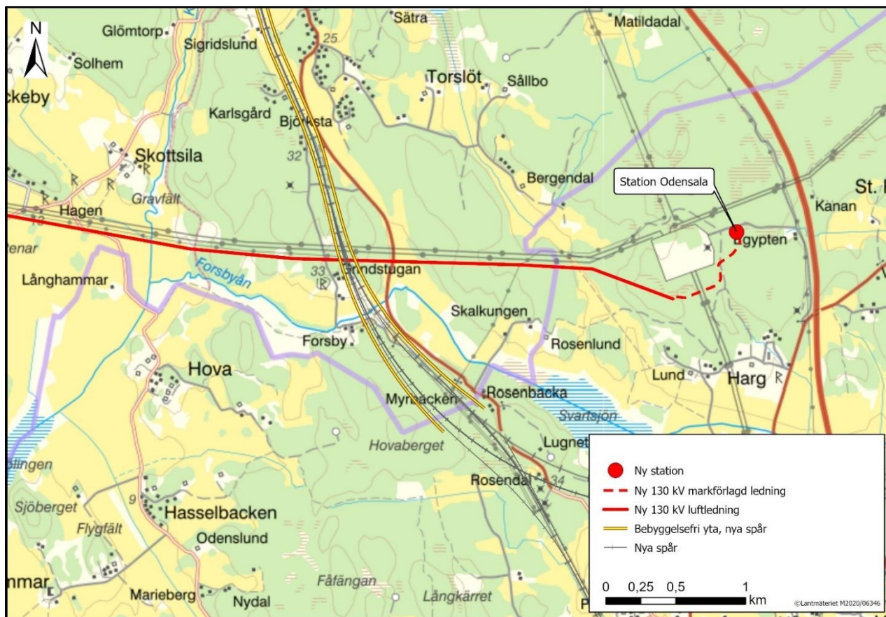
Figur 29. Planerad ledning samt planerad utbyggnation av Ostkustbanan.
