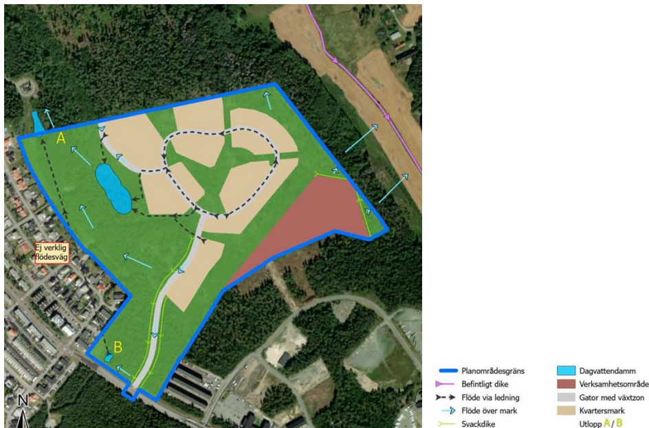
Systemlösning för hantering av flöden inom utredningsområde. Flöde via ledning i västra delen av figuren visar endast att dagvatten transporteras via ledning mellan dammarna, men inte hur ledningen är dragen under marken. (Sweco)
