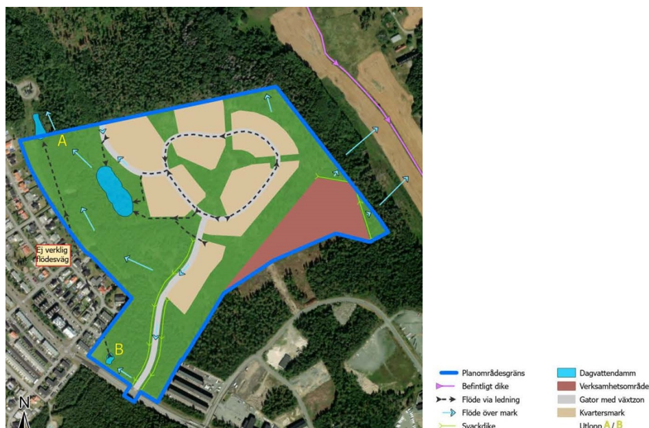
Figur 30: Systemlösning för hantering av flöden inom utredningsområde. Flöde via ledning i västra delen av figuren visar endast att dagvatten transporteras via ledning mellan dammarna, men inte hur ledningen är dragen under marken. (Sweco)
