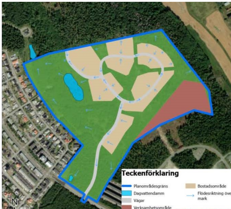
Figur 28: Sekundära avrinningsvägar vid skyfall, då vatten rinner på markytan. Utredningsområde redovisas med blå linje. (Sweco)
