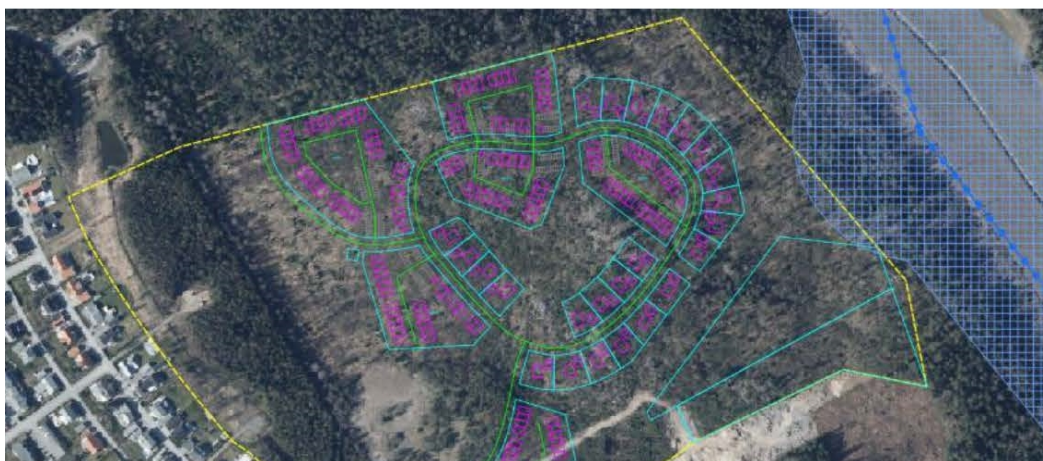
Illustration av maximal utbredning av område med magnetfält som överstiger 0,4 \mu T från kraftledningen (blårutigt område). Illustrerat avstånd är 120 meter och gäller vid vinkelstolpar. Från själva kraftledningen (rak sträckning) är 85 meter ett maxvärde. Bilden är schematisk och gjord på en tidigare version av strukturförslaget. (Briab)
